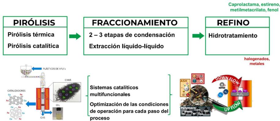
Figura 6. Esquema de etapas principales del proceso de reciclado químico aplicado a los componentes plásticos de VFU's. Fuente: propia
