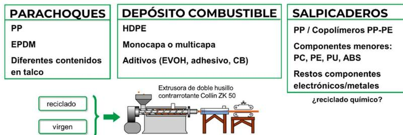
Figura 5. Esquema de las partes plásticas de VFU's, y su composición, utilizados en el reciclado mecánico, y esquema del proceso de mezclado de material reciclado y virgen en una extrusora. Fuente: propia
